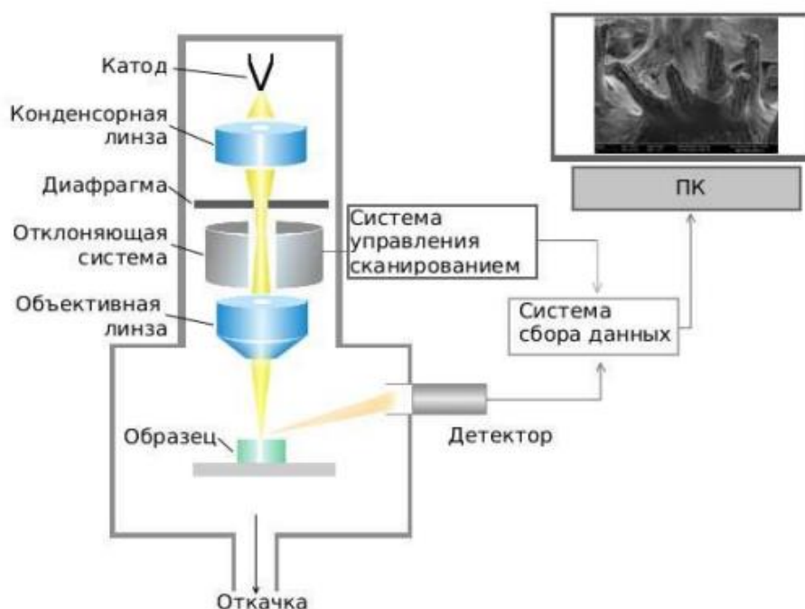
Рисунок 19 – Принципиальная схема сканирующего электронного микроскопа [133]
