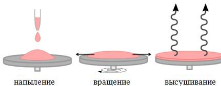
Рисунок 14 – Схематическое изображение метода центрифугирования [123]
