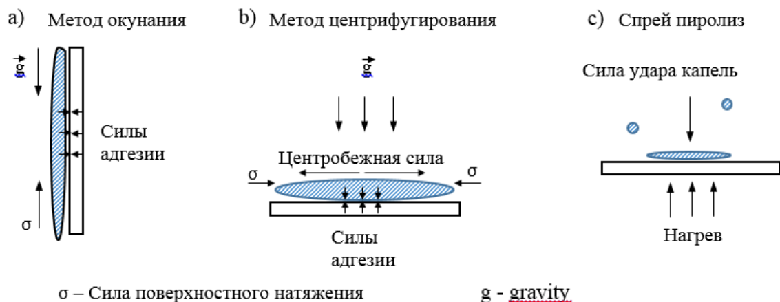
Рисунок 15 – Схема распределения сил в зависимости от способа нанесения [125]
